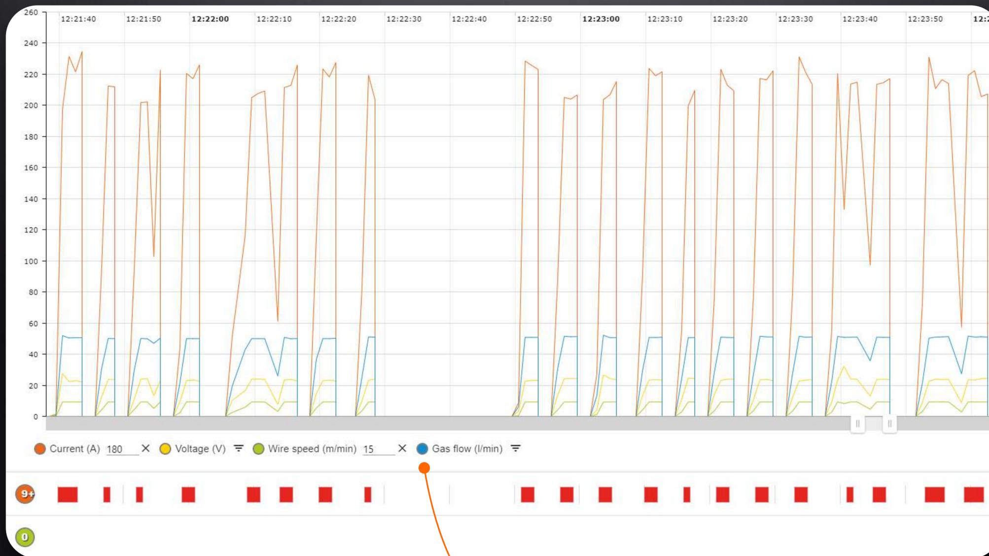
Весь процесс сварки показан на графике. Фильтры позволяют выбрать сварочные соединения, выполненные с отклонением от требуемой технологии.
