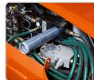
Автоматическая система смазки инструмента, включая Насос, как стандартное оборудование.
