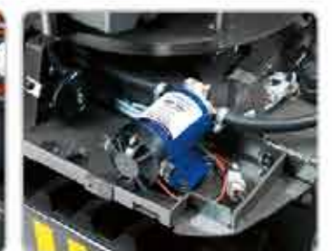
Электрический насос заполнения гидробака.
