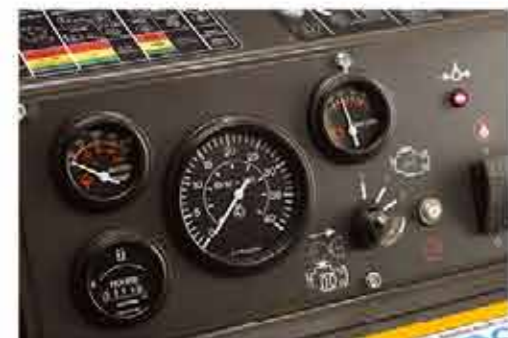
Тахометр/указатель оборотов показывает скорость вращения двигателя или вала диска. Диапазон скорости вращения вала диска имеет цветовую кодировку, соответствующую положению рычага передач.
