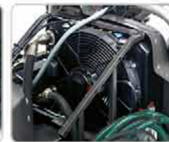
Электрический вентилятор, обеспечивающий максимальное охлаждение.
