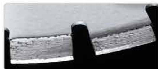
Режущие диски F685 снабжены утопленными или заниженными сегментами для защиты от подрезания и предохранения от износа стального корпуса диска.
