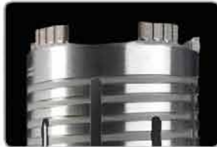
Благодаря вентиляционным пазам, специальным канавкам между сегментами и увеличенной ширине сегмента, пыль удаляется очень эффективно.
