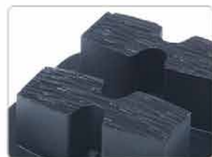
Форма сегментов Husqvarna обеспечивает большее количество активно работающих алмазов по сравнению с базовыми прямоугольными сегментами для более интенсивной шлифовки. Предварительно заточенные сегменты позволяют алмазному инструменту работать с 100% эффективностью с самого начала резки, правка инструмента не требуется.
