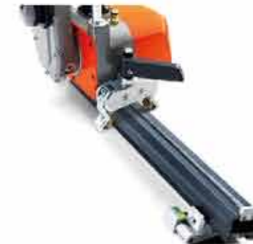
Быстрая установка головки резчика на рельс.
