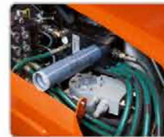
Автоматическая система смазки инструмента, включая Насос, как стандартное оборудование.
