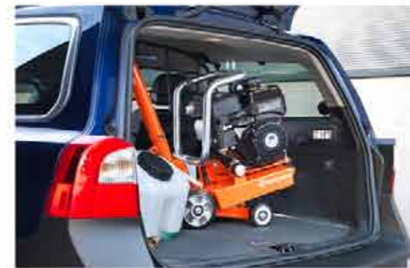
При сложенной рукоятке резчик легко укладывается в легковом автомобиле.
