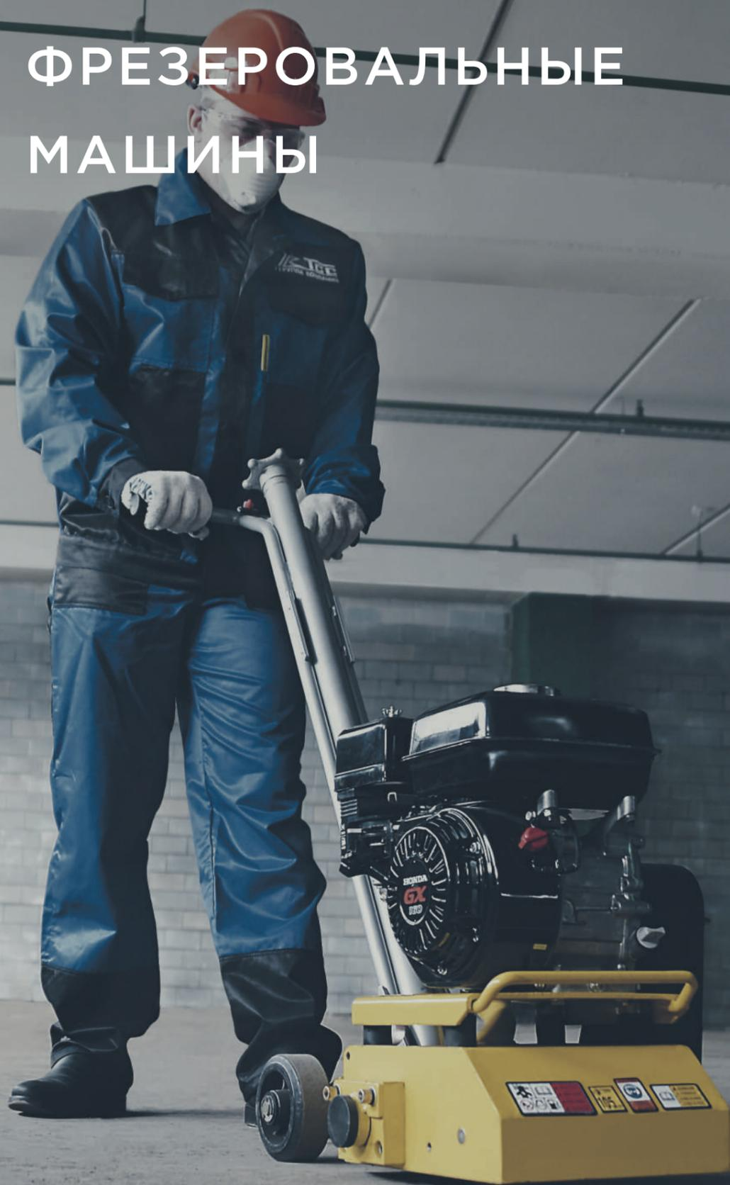
Бензиновые фрезеровальные машины ТСС - это универсальный вариант для строительных и дорожных работ, используются для различных видов поверхности, таких как бетон, асфальт, стальная поверхность и др. Рабочим элементом данного фрезера является барабан, на котором в шахматном порядке расположены металлические звездочки (ламели), снимающие поверхностный слой основания.
